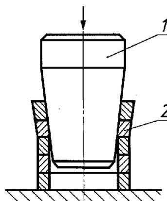
1 — оправка с цилиндрической частью; 2 — кольцевые образцы
