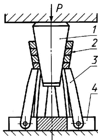
1 — коническая оправка; 2 — кольцевые образцы; 3 — стойки; 4 — основание
